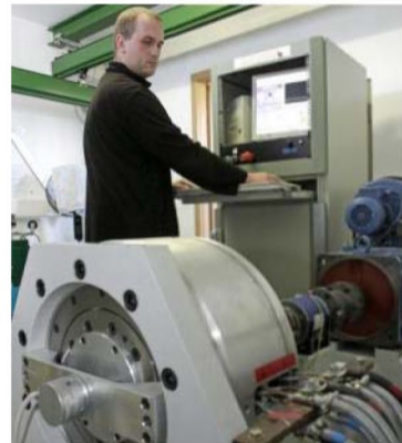
BITSz-Mitarbeiter Stefan Gnüchtel am hauseigenen Motorenprüfstand. Hier werden alle Leistungsparameter des kompletten Antriebssystems getestet.
